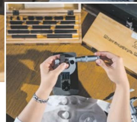
Калибровка микрометра с использованием плоскопараллельных концевых мер длины
