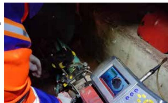
Современные методы неразрушающего контроля позволяют экспертам ЭМС заранее предвидеть возможные неполадки в работе инженерных устройств и находить скрытые дефекты на основе параметров вибрации оборудования. Над этой задачей работает лаборатория вибродиагностики.
