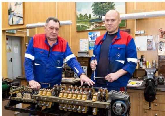
Мастер АААО Алексей Дольников и слесарь по ремонту подвижного состава Александр Мосиенко осматривают реостатный контроллер
