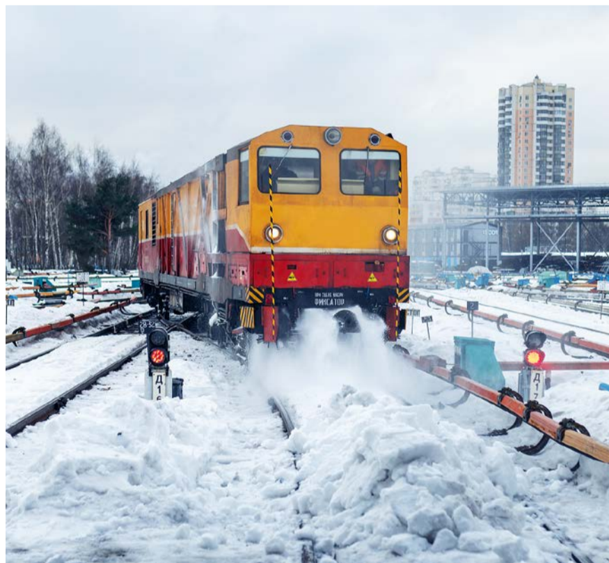
Снегоуборочная машина метрополитена до сих пор в деле. Это доработанный образец – СММ-2, но главные принципы его конструкции те же, что были заложены авторами изобретения в 70-х годах
